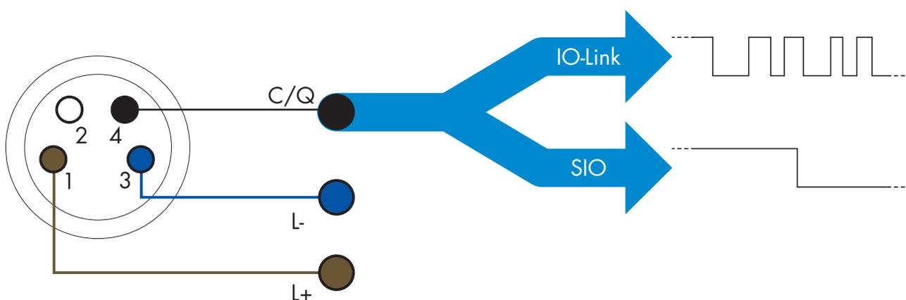
La comunicación IO-Link tiene lugar con una modulación de impulso de 24 V, el protocolo estándar UART por medio del cable de conmutación y comunicación (canal combinado de datos y de estado de conmutación C/Q), PIN 4 o un cable negro.
