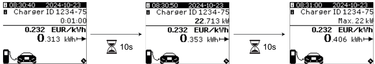
Figur 21 Opladningssession i gang, med TT-felt, systemeffekt, brugerdefineret streng 1 og 2 aktive. Tidsudløseren er indstillet til 10 sekunder.
