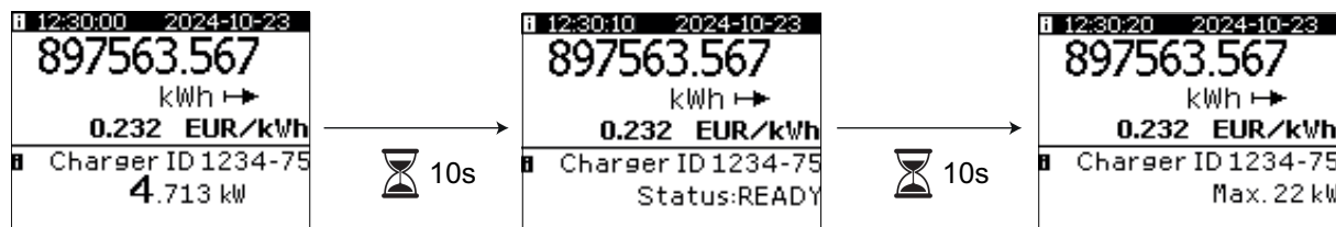
Figur 12 Startside: side 1 med TT-felt, tilpasset streng 1 og 2 aktive. rotationstid er indstillet til 10 sekunder.
