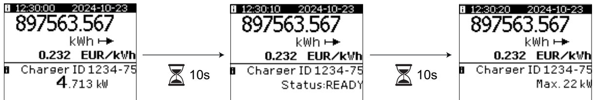
Abbildung 12 Startseite: Seite 1 mit angezeigtem TT-Feld sowie den benutzerdefinierten Zeichenfolgen 1 und 2. Die Rotationszeit ist auf 10 Sekunden eingestellt.
