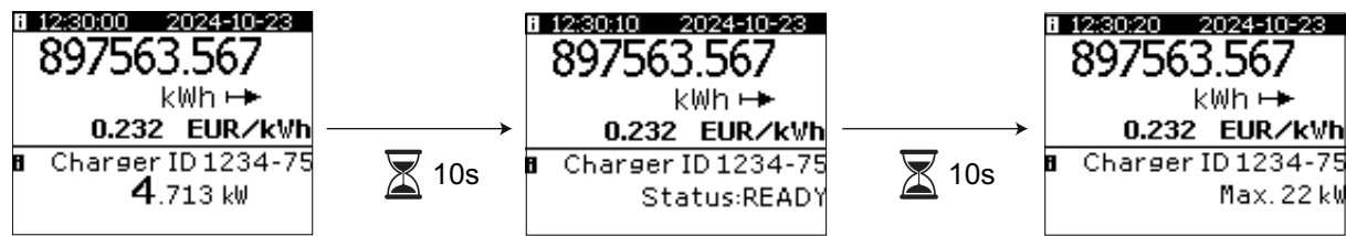
圖 12 主頁：顯示 TT 欄位、自訂字串 1 和字串 2 的頁面 1。輪換時間設定為 10 秒。
