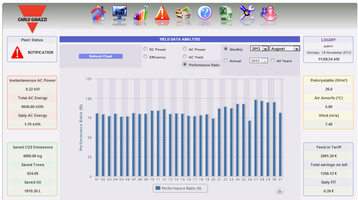
Abb. 107 – Graphik monatlicher Leistungsgrad (erzeugter Strom/erwartete Leistung)(%)
