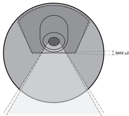
**Fig. 8** Massimo scostamento orizzontale  $\pm 2^\circ$
