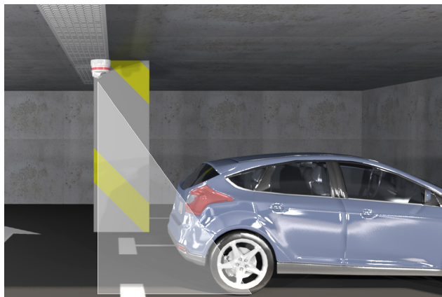
Posizionare SBPBASEA sulla destra del vano portacavi
