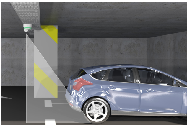
SBPBASEA è montata erroneamente sulla sinistra del vano portacavi
