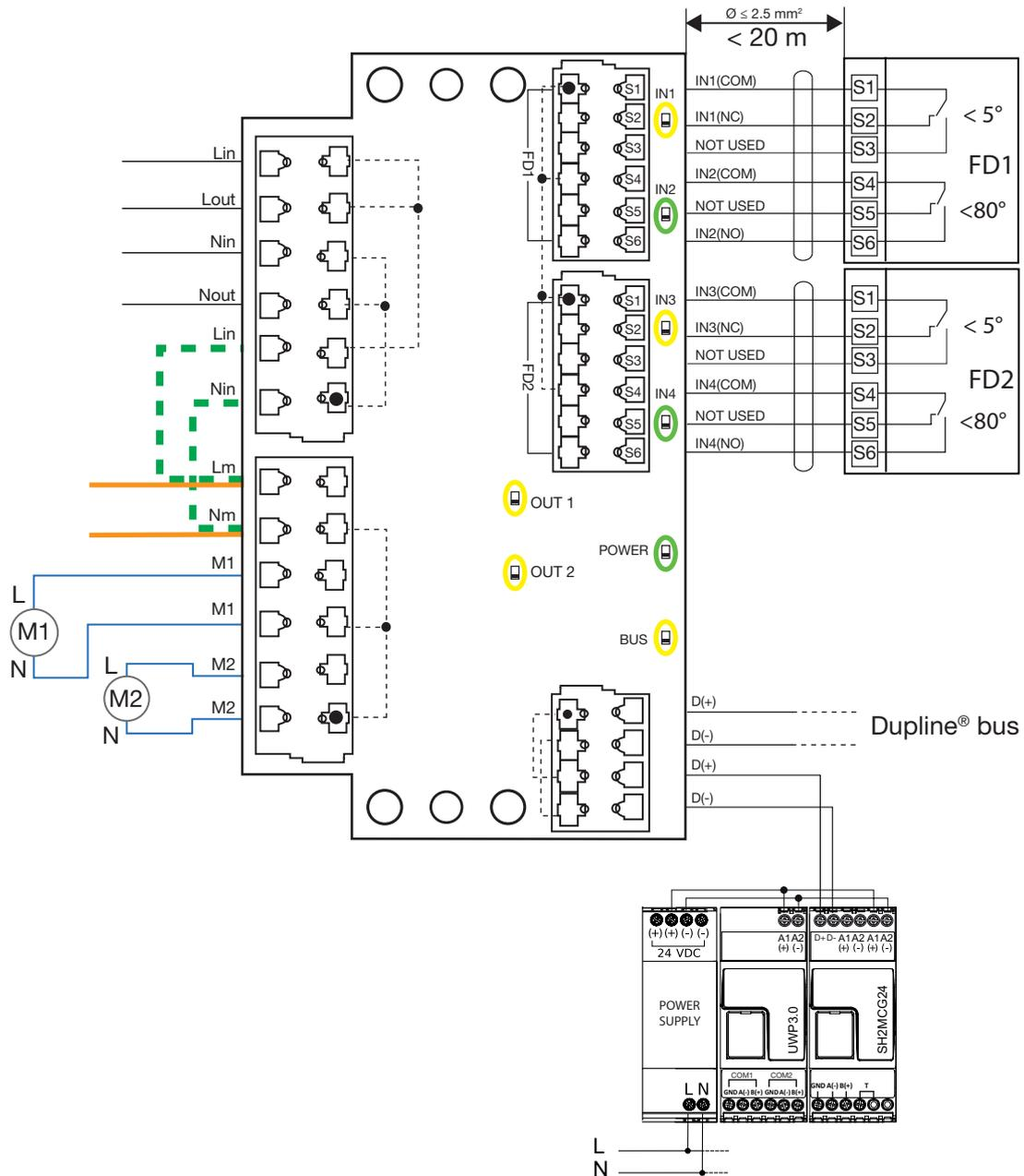
Fig. 1 Esempio di collegamento di due serrande tagliafuoco
