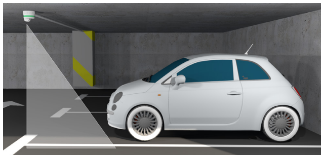
Le véhicule a été stationné trop loin du capteur
