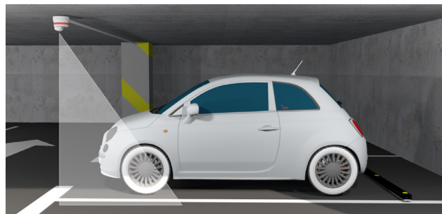
Les blocages des roues évitent de se stationner trop loin du capteur
