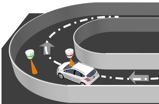
Una de las SBPBASEB juntas con los sensores está demasiado lejos del medio del pasillo
