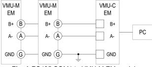
Fig. 1 RS485 COM1 to VMU-M EM modules
