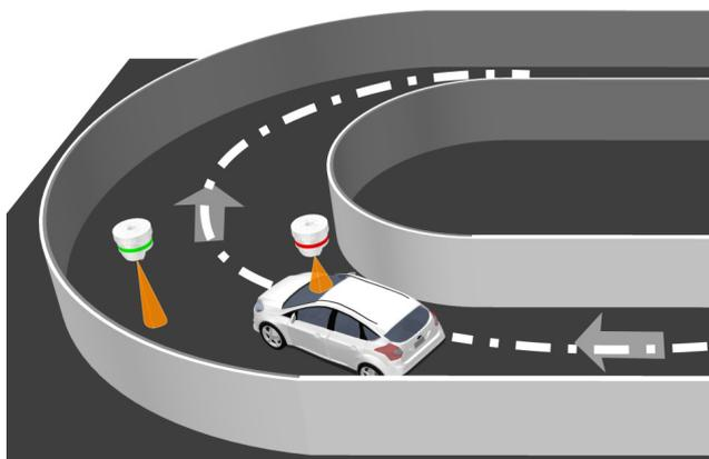
Einer der Sensoren wurde zu weit von der Mitte der Fahrspur entfernt platziert
