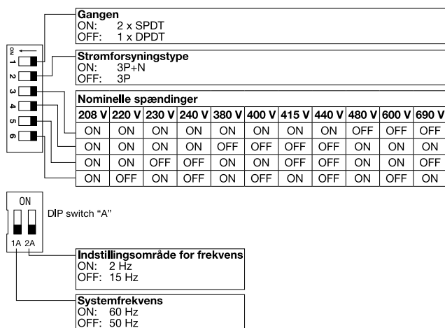
Fig. 1 DIP indstillinger M44
