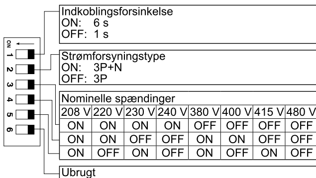
Fig. 1 DIP indstillingstabel M44
