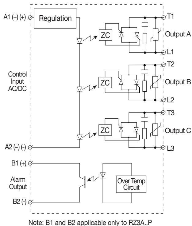
**Fig. 1** Terminal wiring
