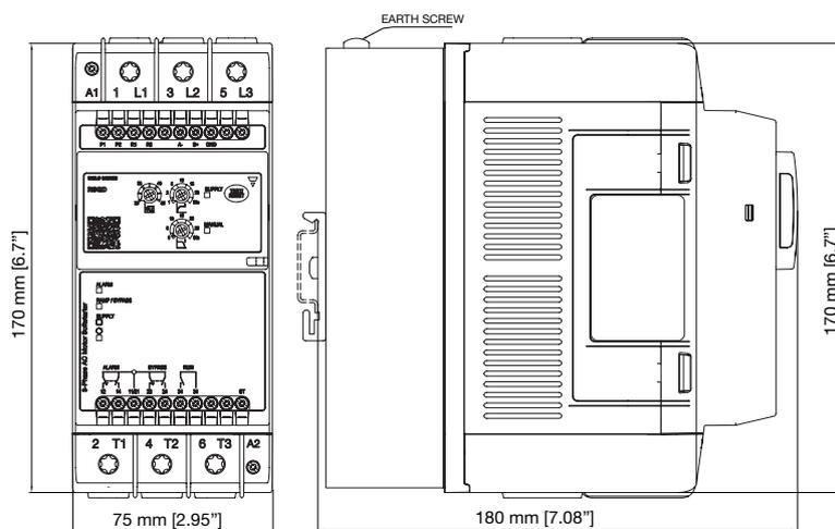
Fig. 3 RSGD.55..VX310C 至 RSGD..85..VX310C ( DIN 导轨式安装版本 )
