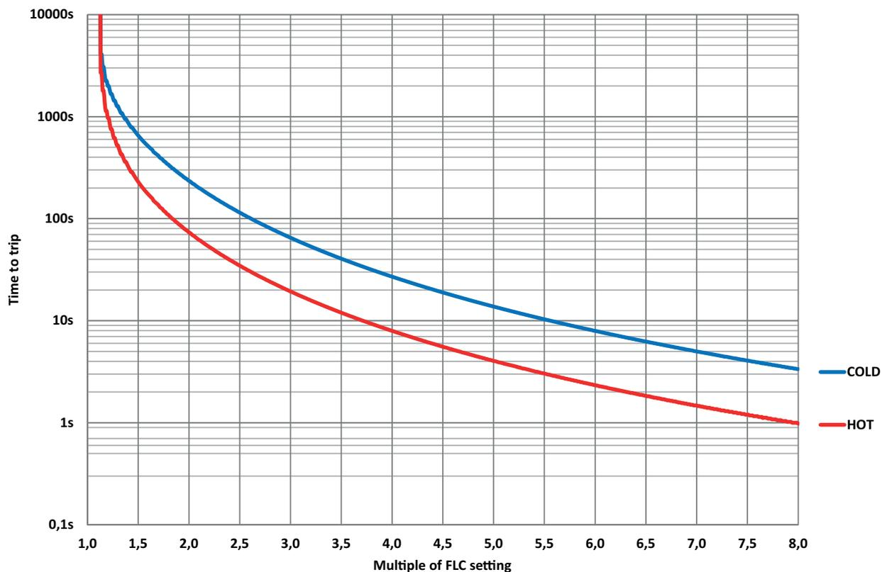
Fig. 11 RSGD 10 级电机过载脱扣分布图
