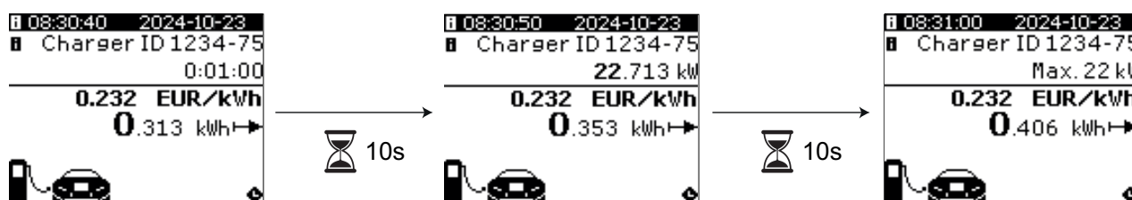
图7 在充电工作阶段正在进行中，TT 字段、系统功率、自定义字符串 1 和自定义字符串 2 处于激活状态。时间触发设置为 10 秒。
